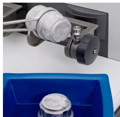
在研磨之前，将研磨罐浸入冷冻盒的液氮中 (-196 °C) 约 2-3 分钟。
