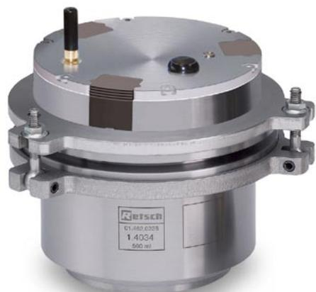
PM 研磨监控系统可适用于 250 ml 和 500 ml 的不锈钢制研磨罐。数字信号由集成在研磨罐盖内的发射器发送，固定接收器与电脑相连，负责信号的接收。信号为单向传输模式，每秒可传送多达 200 个测量值。信号传输协议完全符合工业安全标准。数据经传送至电脑后，可通过 Office 办公软件处理。
