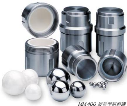
MM 400 旋盖型研磨罐
