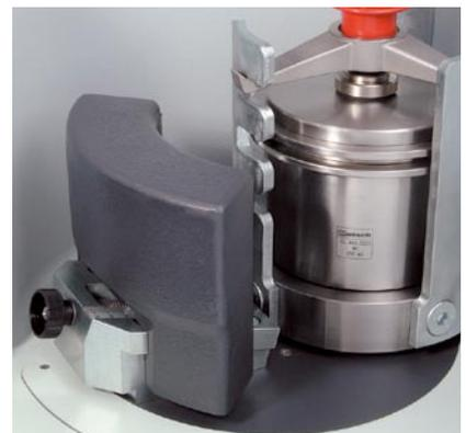
为优化离心力平衡，PM 100 可以通过配重在倾斜导轨上的滑动以得到最佳效果。
