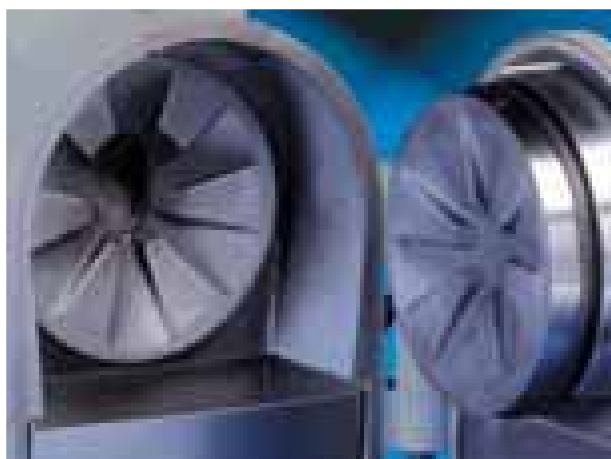
盘式研磨仪 DM 200 的研磨室视图 (研磨盘具有渐进式的啮齿设计)
